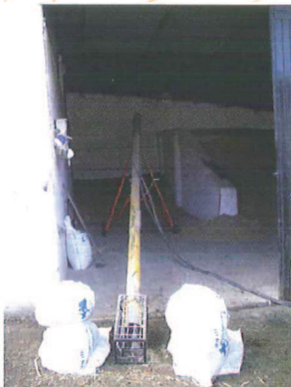
Vista del elevador de cereales o "sin fin"
