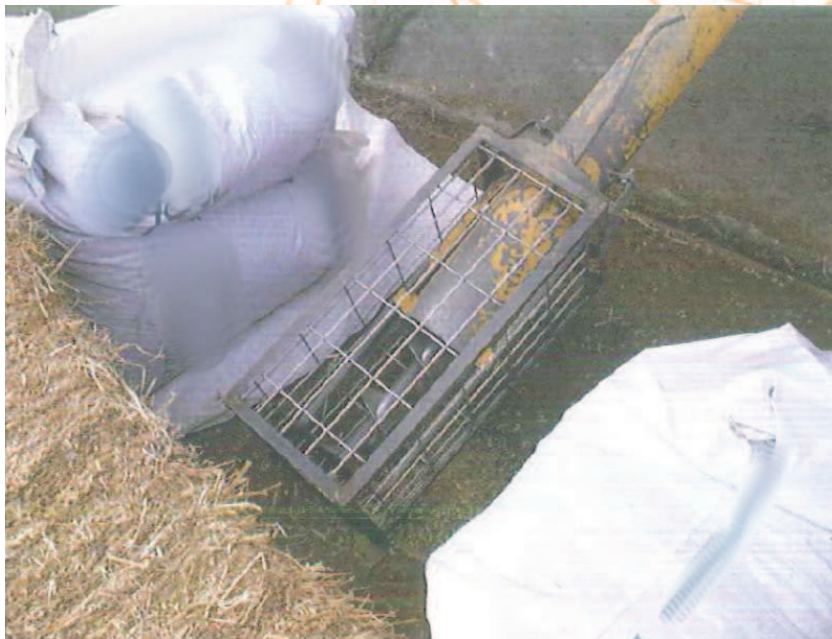
Detalle de la boca del "sin fin" después del accidente
