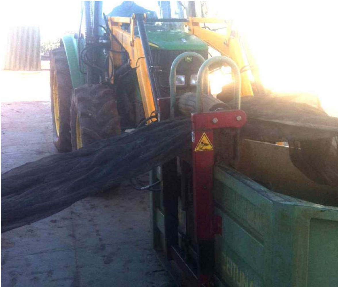
Imagen 2. La función de los rodillos es aprisionar y arrastrar los fardos donde han caído las aceitunas, para que queden depositadas en el cajón "lateral volteable".
