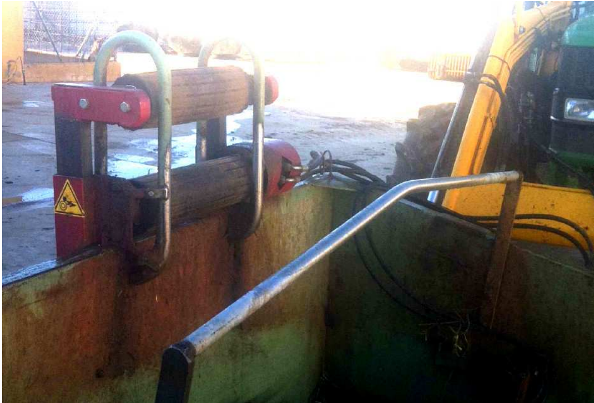
Imagen 1. Detalle del equipo de rodillos motorizados acoplado al cajón contenedor de aceitunas.
