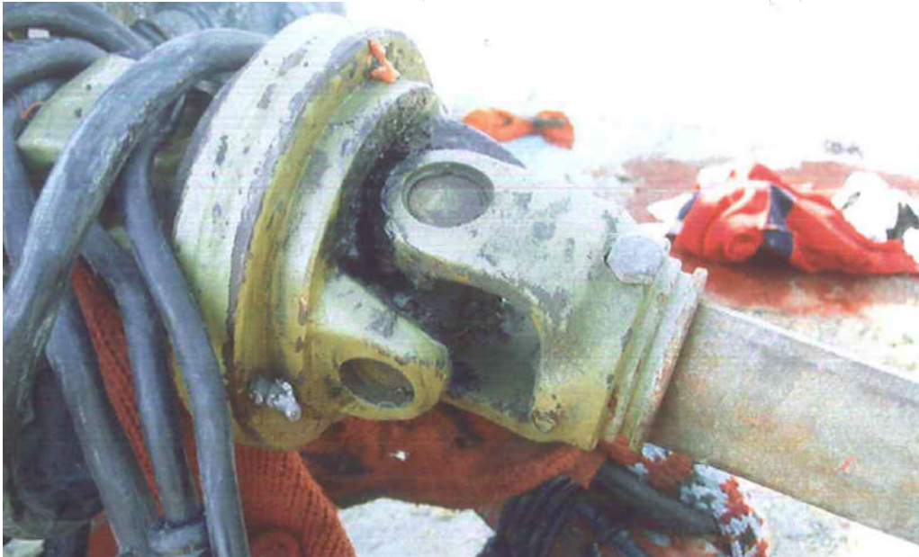
Foto 3. Detalle del mecanismo cardán sin resguardo.
