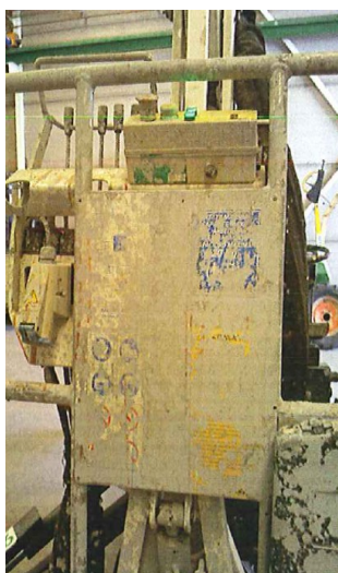
Imagen 4. Puesto de mando en la cesta. Se observan los pilotos testigos que luciendo en verde habilitan el uso de la máquina desde arriba. También dispone de parada de emergencia y de testigo de sobrepeso, que evita poder ser utilizada si en la canasta se carga con más de 120 kg.
