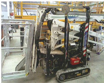
Imagen 2. Plataforma elevadora en la que ocurrió el accidente, en posición recogida.
